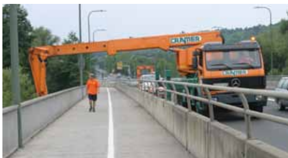
Überkragung von über 6 m breiten Gehwegen
