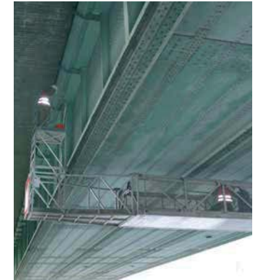
Einsatz mit Stegverlängerung auf 19,00 m Reichweite: 19,70 m
