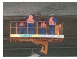
Für Prüfungs- und Sanierungsarbeiten an Brücken ist die Superplattform wegen ihrer großen Arbeitsfläche und hohen Nutzlast besonders geeignet.
